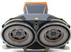
49 cm Arbeitsbreite, sowie Magnetbefestigung für einfache Montage und Demontage. Erhältlich mit Pad-Halterungen, Twister- und Standard Pads.
